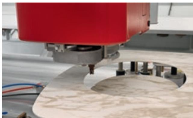
È possibile allestire il piano di lavoro con fino ad un massimo di 40 ventose telescopiche, che possono differire in dimensioni e forma. Le ventose telescopiche sono gestite automaticamente dal software bordo macchina, e programmate attraverso le specifiche funzionalità CAM sviluppate da Intermac. Sono disponibili 4 diverse configurazioni:
